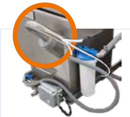
Llenado automático del líquido
